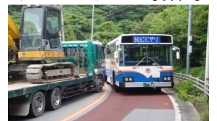
▲線形不良による大型車のすれ違い状況【写真2】
